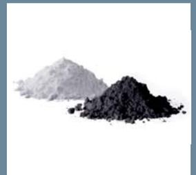
Berghof verwendet reines s-PTFE, das im Gegensatz zu e-PTFE aus einer Suspension gewonnen wird und daher ohne Emulgatoren auskommt. Das bedeutet, Druckausgleichselemente von Berghof sind vollkommen frei von Fremdstoffen wie Porenbildnern oder dem Emulgator Perfluoroctansäure (PFOA), der im Verdacht steht, krebserregend zu sein.
